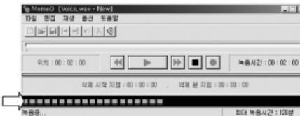
윗 그림에서 레벨미터 최대치가 적색으로 가지 않도록 보이스펜의 볼륨 및 컴퓨터의 MIC 입력 볼륨을 적절하게 조절합니다. (음량이 크거나 작으면 잡음이 발생합니다.) 레벨미터가 움직이지 않으면 오디오케이블 연결이 올바르게 되었는지를 확인합니다.
